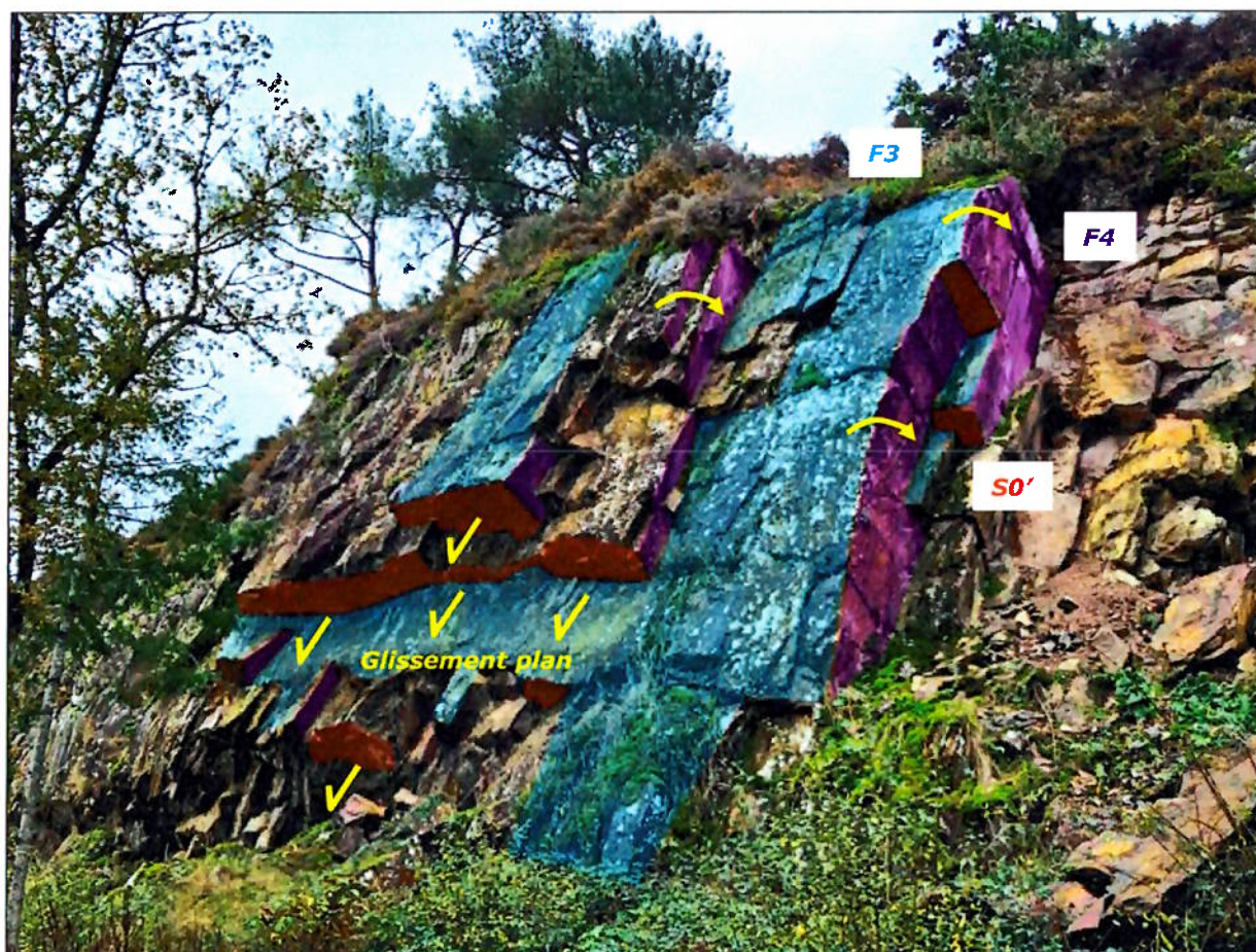
Photographie du secteur ordovicien avec les familles de discontinuités, formant des glissements plans.
